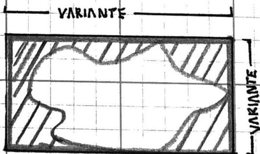
Se realiza con cortadora de disco y demolición a mano de pavimento asfáltico. Espesor promedio.
