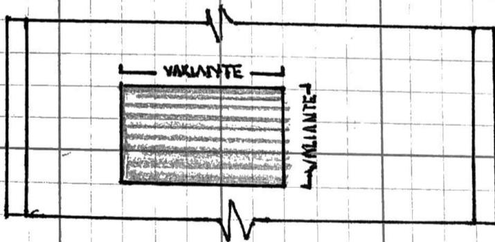
Excavación a mano en cepa. con profundidad variable de 0.0 a 0.07 cm.
